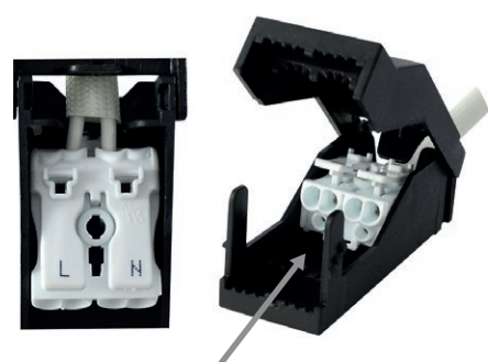
DOUBLE CONNECTION CLIPSABLE POUR MONTAGE EN SÉRIE ( sans outils )
